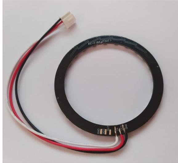
Abbildung 7 24Bit 2812b LED-Ring (Auslieferungszustand)
