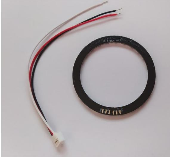
Abbildung 6 24Bit 2812b LED-Ring
