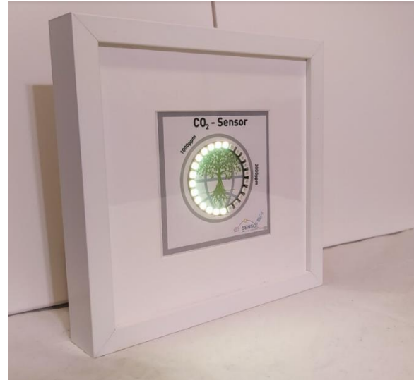
Abbildung 1 CO 2 -Sensor im Bilderrahmen
