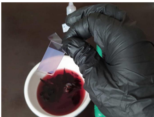
Abbildung 6 Entnehmen des TiO 2 Glasplättchens
