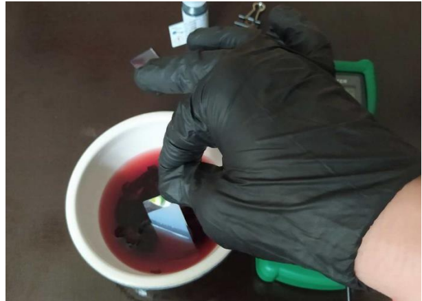
Abbildung 3 Eintauchen des TiO 2 -beschichteten TCO-Glasplättchens
