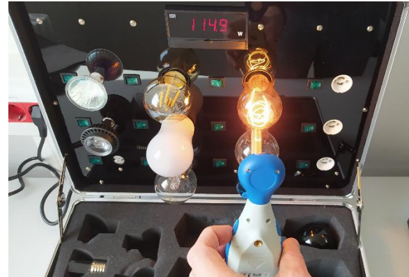
Abbildung 6 Messung des Leuchtmittels mittels Luxmeter
