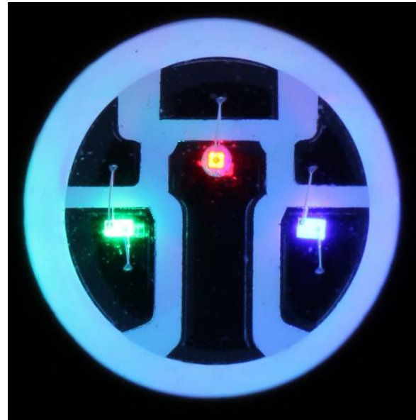
Abbildung 15 RGB-LED SMD 5050 Makroaufnahme
