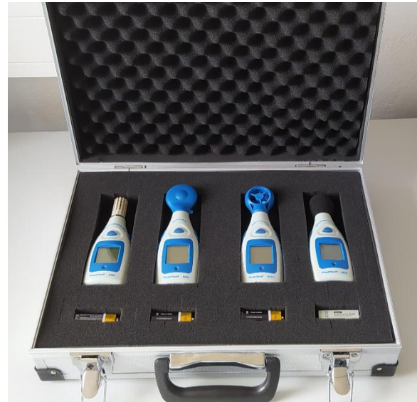
Abbildung 3 Messgerätekofter (von links) Thermometer, Luxmeter, Anemometer, Lärmpegelmessgerät
