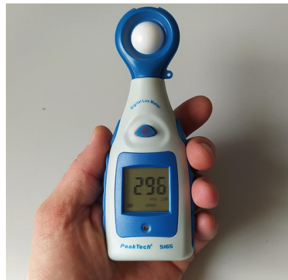
Abbildung 7 Ablesen des gemessenen Beleuchtungswertes (hier 296 \cdot 10 = 2960 Lux)
