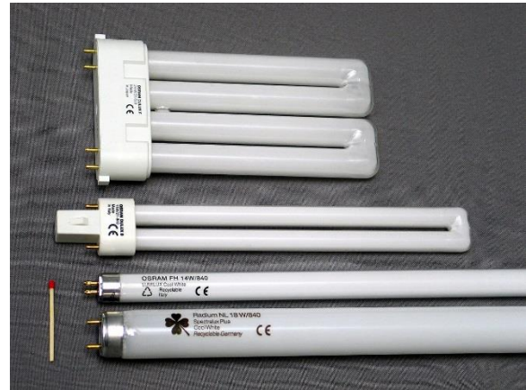
Abbildung 13 Verschiedene Typen von Leuchtstofflampen, © Christian Taube 5
