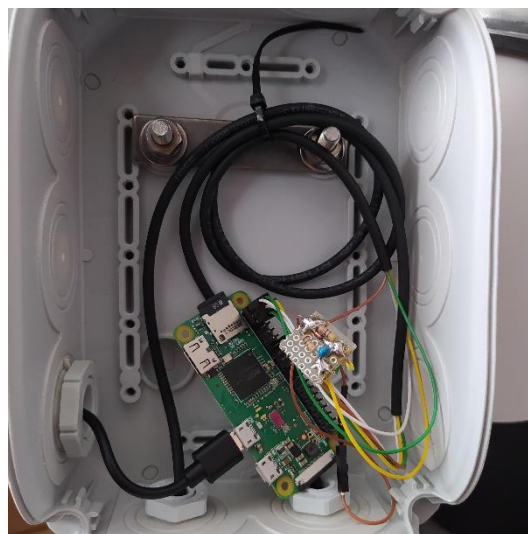
Abbildung 6 Anschließen des Raspberry Pis
