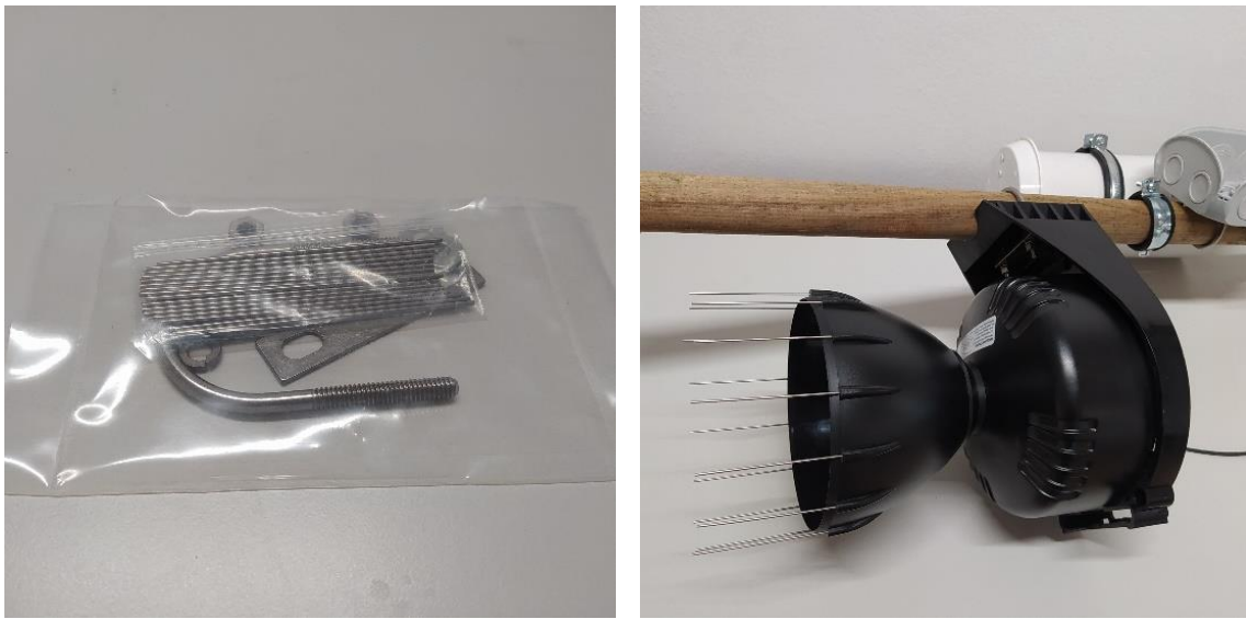
Abbildung 5 Montage des Niederschlagssensors
