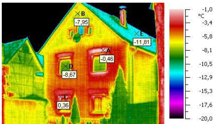
Abbildung 3 Wärmebild einer Hausfassade (Winter), © Lutz Weidner 1
